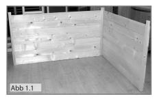
1. Zu Beginn stellen Sie die rechte Seite und die Rückwand (Teil I unten gerade) wie in Abb.1.1 so aneinander, dass die Schrauben außen sichtbar sind. Verschrauben Sie die Seite mit der Rückwand. (Schrauben 5x80) Verfahren Sie mit der linken Seite ebenso. Die Rückwand wird zwischen den beiden Außenseiten montiert.
