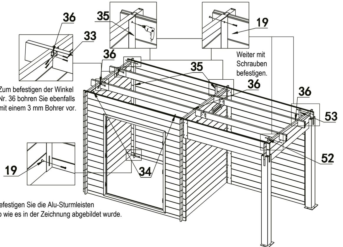
Zum befestigen der Winkel Nr. 36 bohren Sie ebenfalls mit einem 3 mm Bohrer vor.
