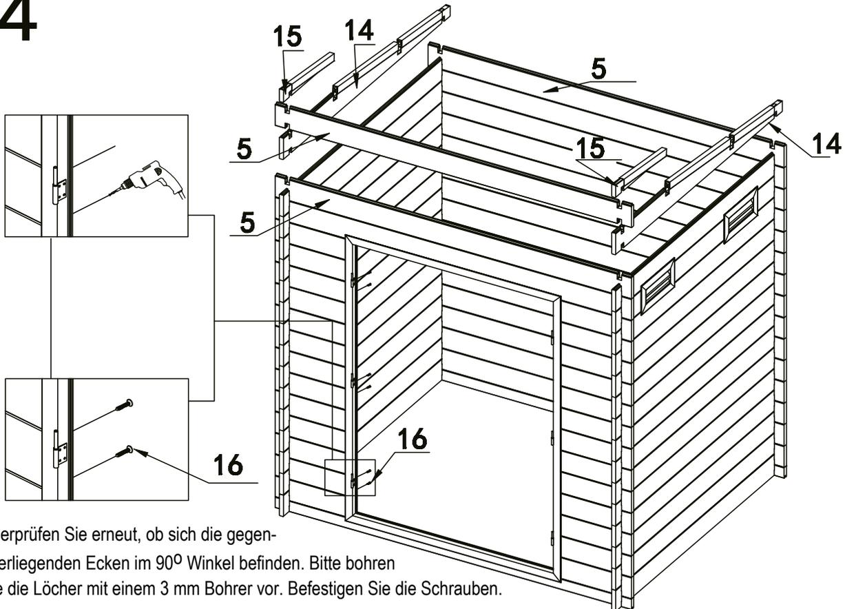
Überprüfen Sie erneut, ob sich die gegenüberliegenden Ecken im  $90^\circ$  Winkel befinden. Bitte bohren Sie die Löcher mit einem 3 mm Bohrer vor. Befestigen Sie die Schrauben.
