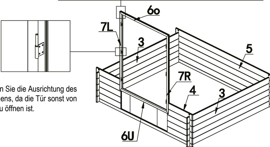
Beachten Sie die Ausrichtung des Türrahmens, da die Tür sonst von außen zu öffnen ist.
