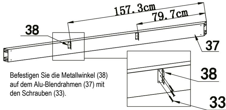
Befestigen Sie die Metallwinkel (38) auf dem Alu-Blendrahmen (37) mit den Schrauben (33).
